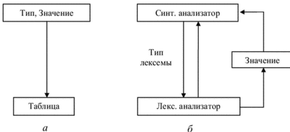
Рис. 7.1 Робота лексичного і синтаксичного аналізаторів
