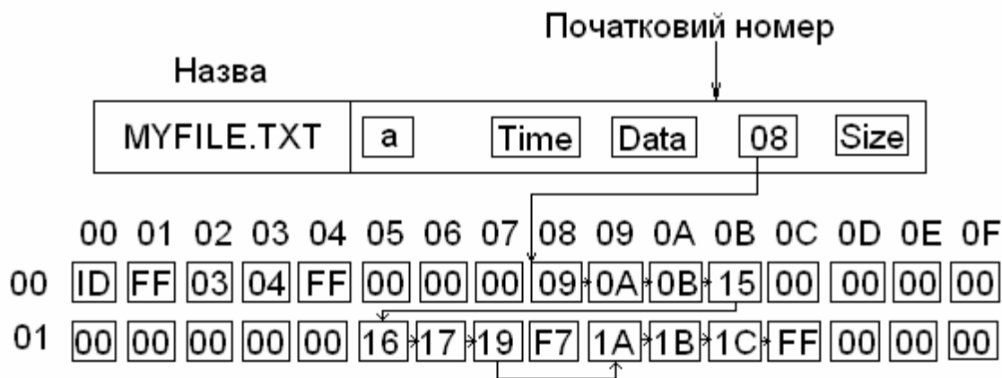
Рис. 6.8. Розміщення файлової системи з використанням таблиць
